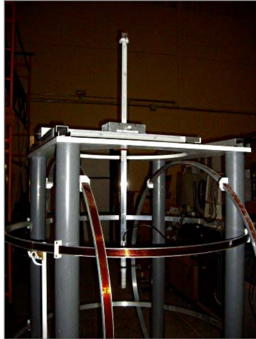
Fig. 5: Soporte con escalas XYZ para la sonda.
